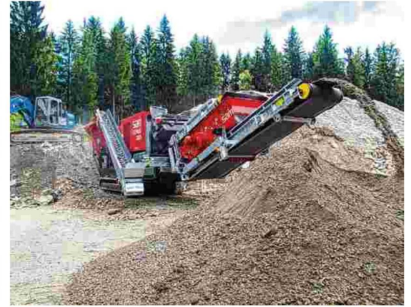
Der Großteil der für Umsetzung des Bauvorhabens benötigten Materialien für die Herstellung der Hauptbaustoffe wird vor Ort gewonnen und aufbereitet.
